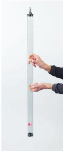
> Un tube de NEWTON est un cylindre duquel l'air est retiré.
